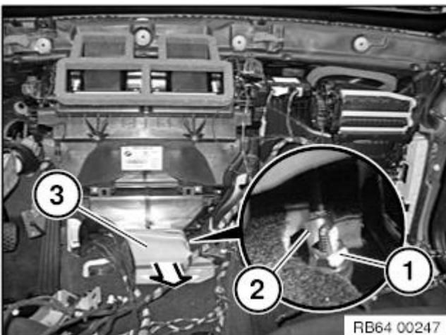
Luftkanal (3) in Pfeilrichtung abziehen.
