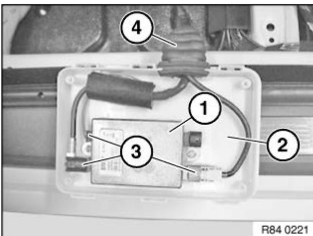
USB-Hub (1) von Unterteil Schutzdose USB-Hub (2) abnehmen.
