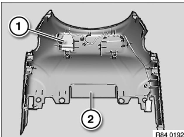
Freisprechmikrofon (1) aus Lenksäulenverkleidung (2) ausklippen und dazugehörigen Kabelbaum aus Lenksäulenverkleidung (2) ausfädeln.
