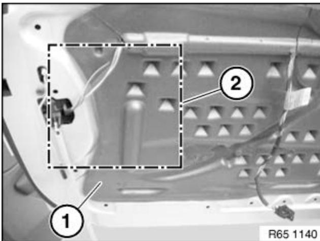
Schallisolierung (1) im Arbeitsbereich (2) lösen.
