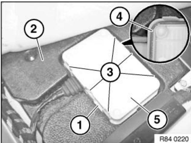
Schutzdose USB-Hub (1) aus Einleger Fußraum (2) entnehmen.
