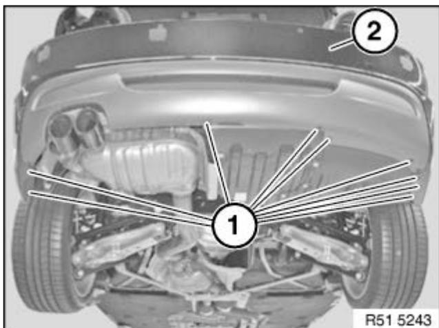
Schrauben (1) an Stoßstangenverkleidung (2) lösen.
