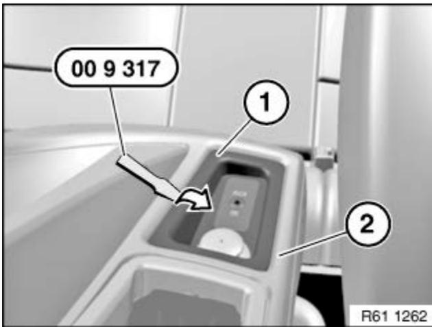
Aufnahme Steckdose (1) oder Blende mit Spezialwerkzeug 00 9 317 von Ablagefach (2) ausheben.
