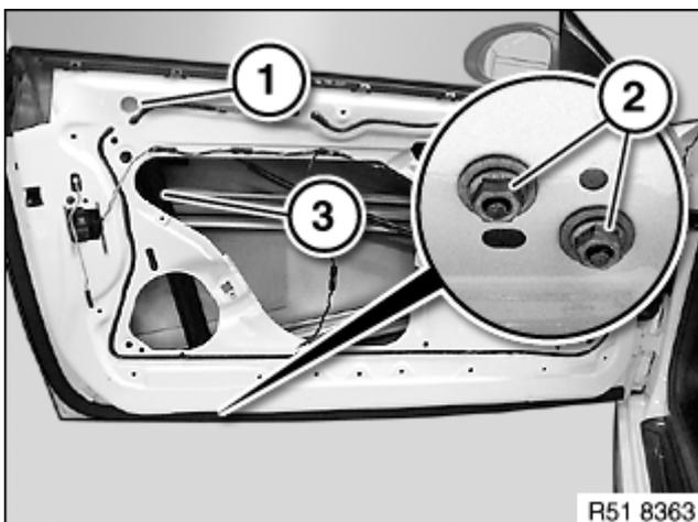
Folie (1) ablösen und darunter liegende Muttern lösen.
