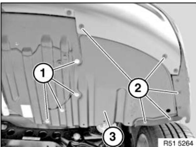
Schrauben (1 und 2) lösen.
