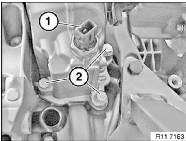
Steckverbindung am Öldruckschalter (1) trennen.
