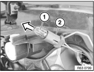
Glühlampe für Standlicht (1) in Pfeilrichtung aus Lampenfassung (2) ziehen.
