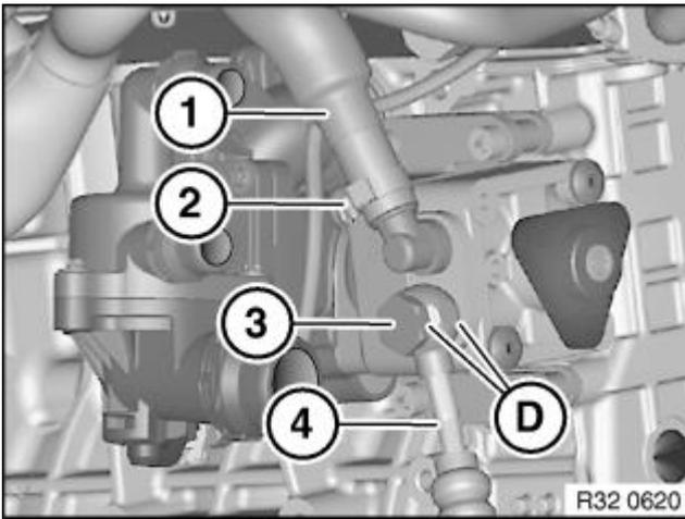
Schlauchschelle (2) lösen und Saugleitung (1) von der Flügelpumpe abziehen.
