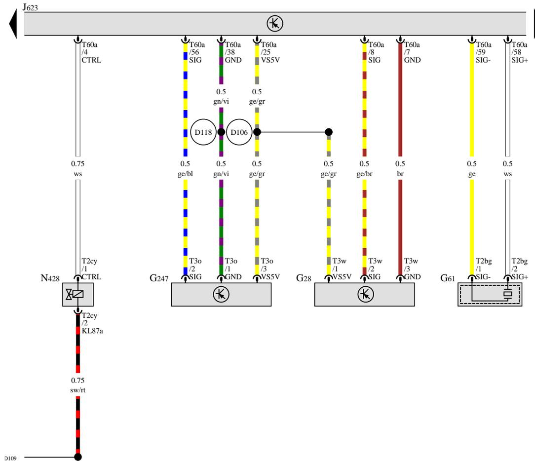
Motordrehzahlgeber, Klopfsensor 1, Kraftstoffdruckgeber, Motorsteuergerät, Ventil für Öldruckregelung
