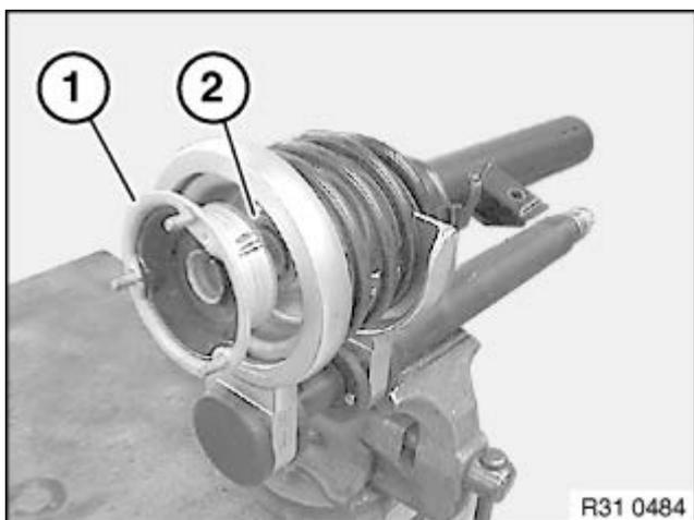
Stoßdämpfer in die gespannte Schraubenfeder
