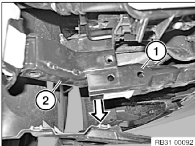
Deformationselement (1) nach unten drücken und Adapter (2) nach oben ausbauen.
