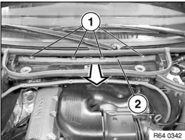
Schrauben (1) lösen und Mikrofiltergehäuse nach vorn abnehmen.
