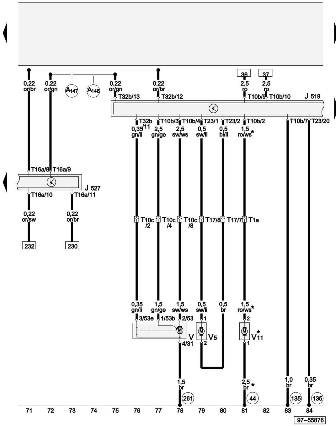
**Steuergerät für Bordnetz, Steuergerät für Lenksäulenelektronik, Scheibenwischermotor, Scheibenwaschpumpe, Pumpe für Scheinwerfer-Reinigungsanlage**
