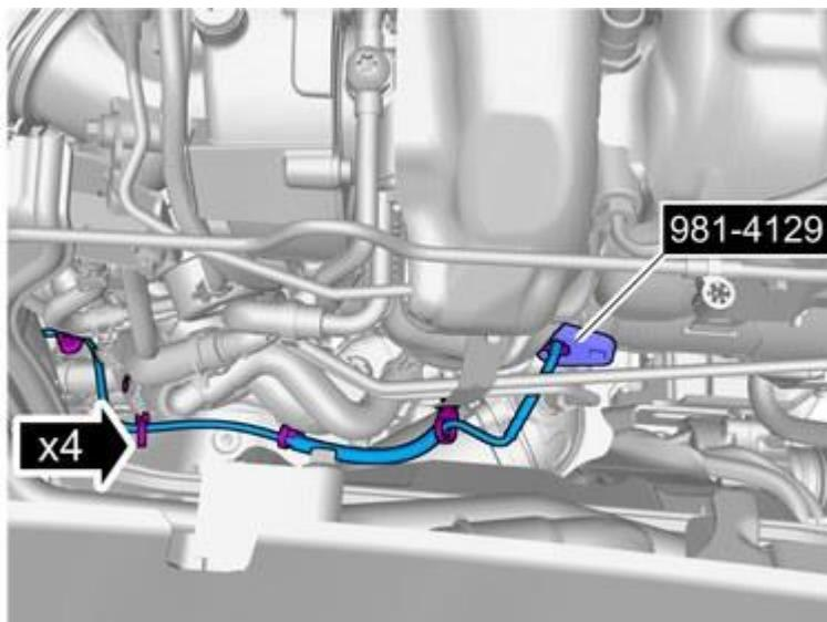
Die Clips des Kabelbaums lösen.
