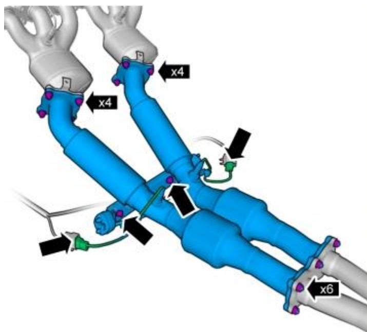
1. Anzugsdrehmoment: Katalysator am Abgaskrümmer, 27 Nm
