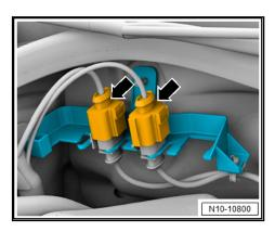
Leitungsführung der Lambdasonden am Fahrzeug ausclip-
