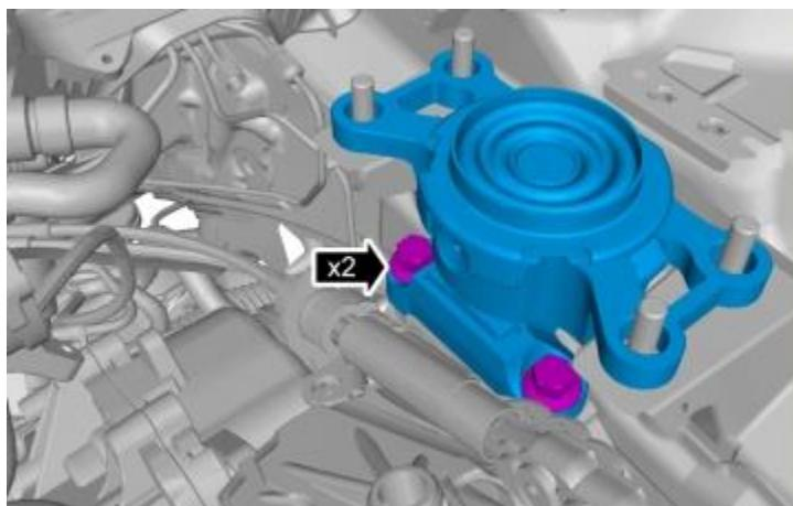
Anzugsdrehmoment: Motor-Momentenstütze links , 175 Nm
