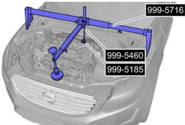
Spezialwerkzeug: **T9995716, 999 5716 HEBEBÜGEL**
