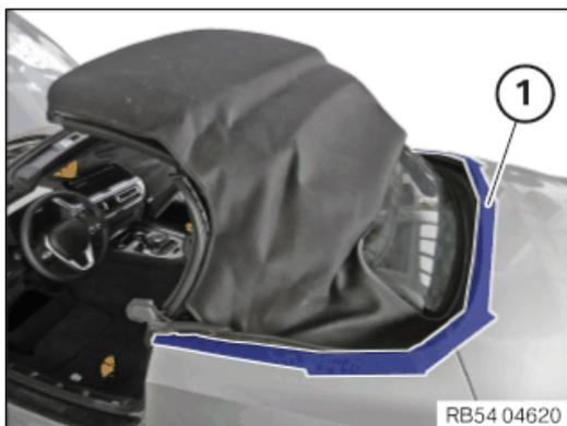
Bereich (1) mit Klebeband vor Beschädigungen schützen.
