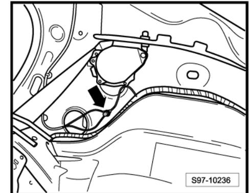
53 - Massepunkt in der Heckklappe rechts -Pfeil-
