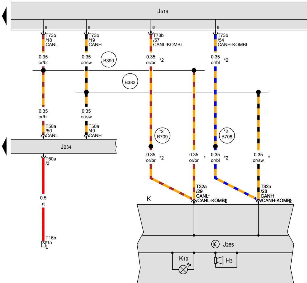
Steuergerät für Airbag, Schalttafeleinsatz
