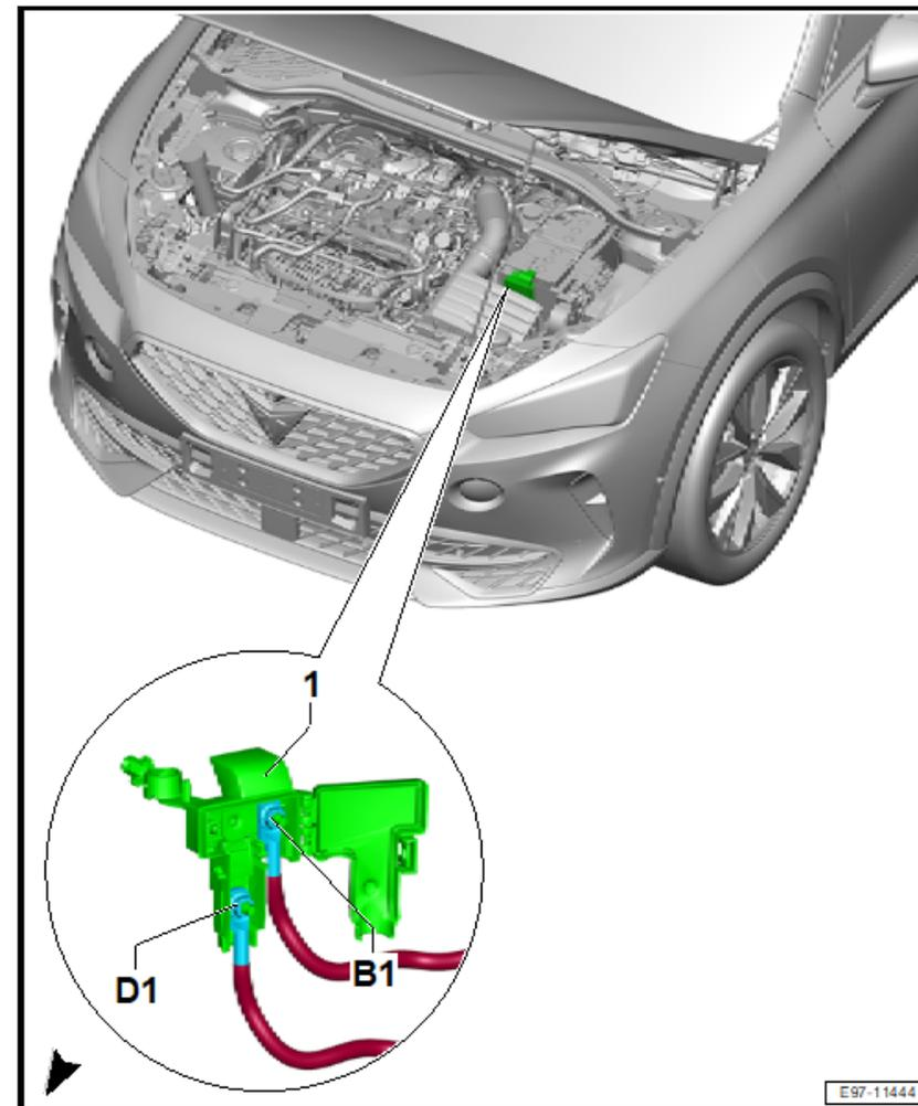
1.1.2 Zuordnung des Anschluss- und Verteilerkastens 2 -SX2-
