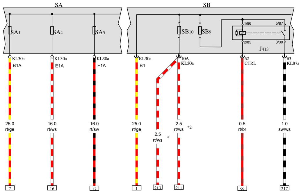
**Relais für Signalhorn, Sicherungshalter A, Sicherungshalter B**
