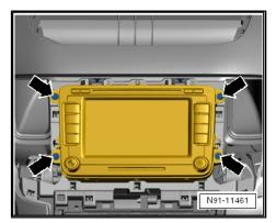
Das Radio - R- / Steuergerät mit Anzeigeeinheit für Radio und Navigationssystem - J503- in -Pfeilrichtung- aus der Öffnung ziehen um Zugang zu den Steckverbindungen auf der Rückseite des Radios - R- / Steuergeräts mit Anzeigeeinheit für Radio und Navigationssystem - J503- zu haben.
