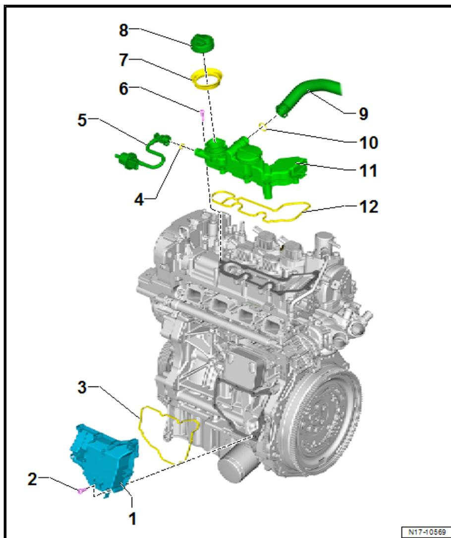
Ölabscheider unten Anzugsdrehmoment und -reihenfolge:
