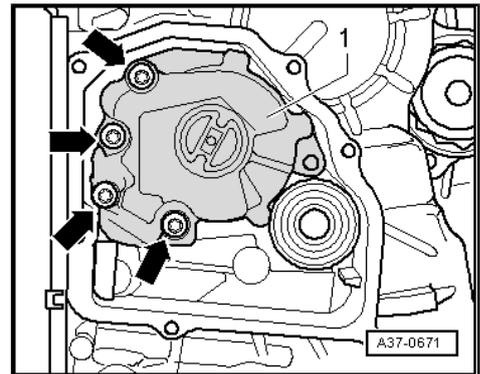
Die obere Schraube muss eventuell mit dem Steckesatz - T10054- ausgebaut werden.
