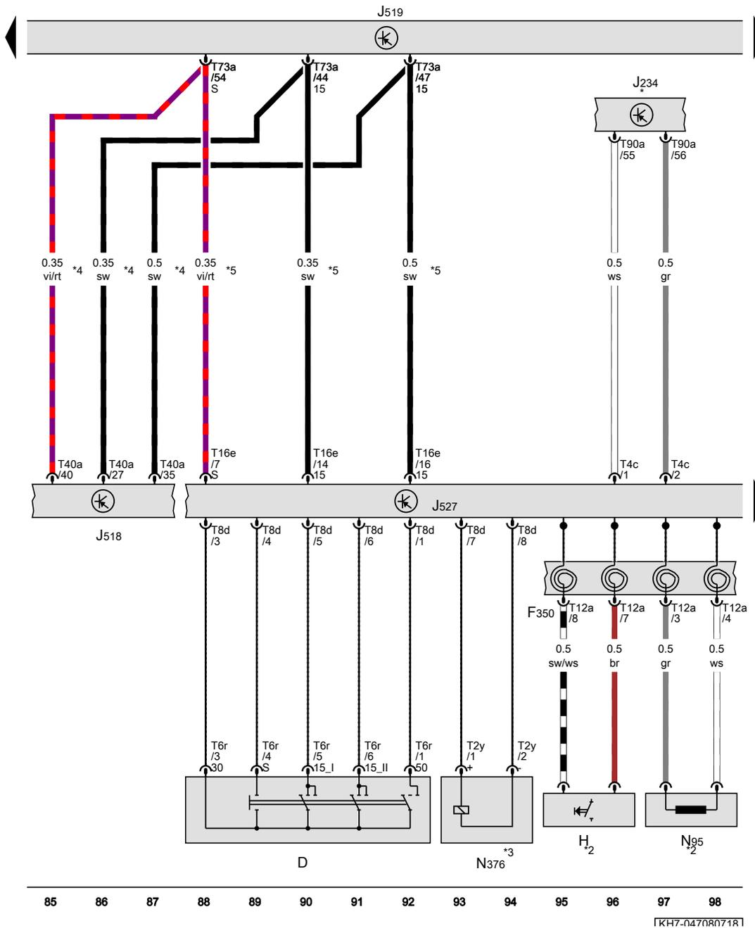
Zündanlassschalter, Signalhornbetätigung, Steuergerät für Airbag, Steuergerät für Zugang und Startberechtigung, Bordnetzsteuergerät, Steuergerät für Lenksäulenelektronik, Zünder für Airbag Fahrerseite, Magnet für Zündschlüsselabzugssperre
