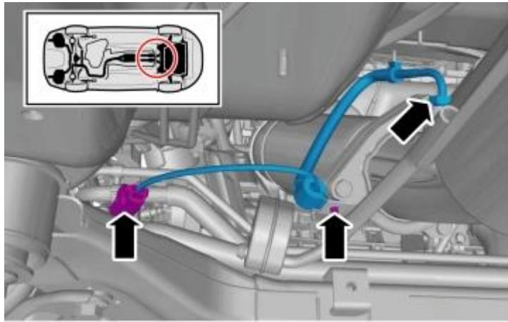
Anzugsdrehmoment: Temperaturgeber Katalysator (hinten und vorne), 45 Nm
