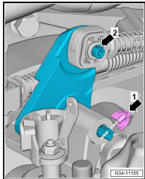
Beim Abnehmen des Umlenkhebels wird gleichzeitig der Wählseilzug von der Arretierung abgezogen.
