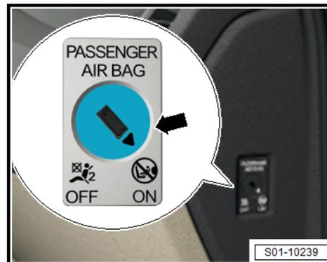
Nach Einschalten der Zündung muss die Kontrollanzeige „PASSENGER AIRBAG OFF“ im Bereich der Innenleuchte in der Dachverkleidung -Pfeil- aufleuchten. Kontrollleuchte leuchtet bei eingeschalteter Zündung dauerhaft.
