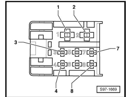
**1.23 Kontaktbelegung Stecker Türsteuergerät hinten links bzw. rechts, 6-fach**
