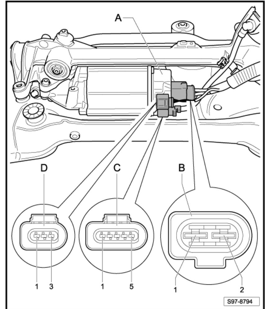
A - Steuergerät für elektromechanische Servolenkung
