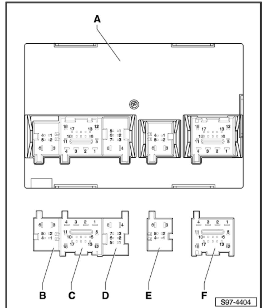
1.20 Kontaktbelegung der Mehrfachstecker am Türsteuergerät Fahrerseite - J386 (bei Fahrzeugen mit Zentralverriegelung)
