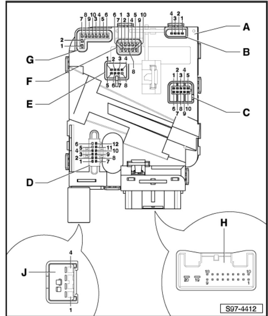
A - Steuergerät für Lenksäulenelektronik
