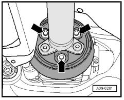
Beim Lösen und Anziehen die Kardanwelle am Achsantrieb hinten gegenhalten.
