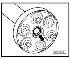
Prüfen, ob an der Gelenkscheibe/Schwingungstilger und am Flansch der Allradkupplung eine Markierung (Farbpunkt) vorhanden ist -Pfeile-. Wenn nicht, Stellung der Gelenkscheibe und des Flansches an der Allradkupplung zueinander kennzeichnen -Pfeile-.
