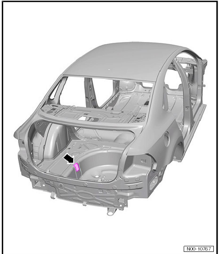
Der Fahrzeugdatenträger -Pfeil- befindet sich hinten in der Reserveradmulde, in Fahrtrichtung links.
