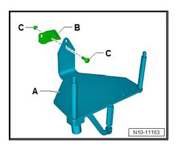
Motorhalter -T10497A- oder -T10497B- -A- wie im Bild gezeigt an den Motor anbauen, handelsübliche Schraube M10 x 20 -1- mit 20 Nm festziehen.
