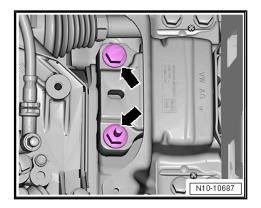
Schrauben -Pfeile- am Getriebelager etwa 2 Umdrehungen herausdrehen.
