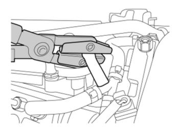
Den Rückführschlauch von den Einspritzventilen mit einer Schlauchklemme festklemmen.
