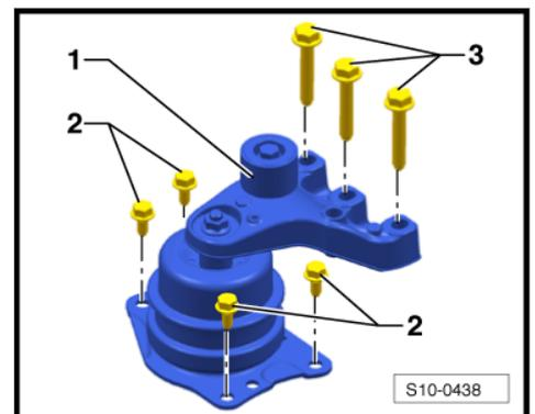
2 - 20 Nm + 90° - nach dem Ausbau ersetzen
