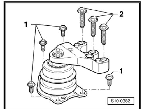
1 - 20 Nm + 90° - nach dem Ausbau ersetzen
