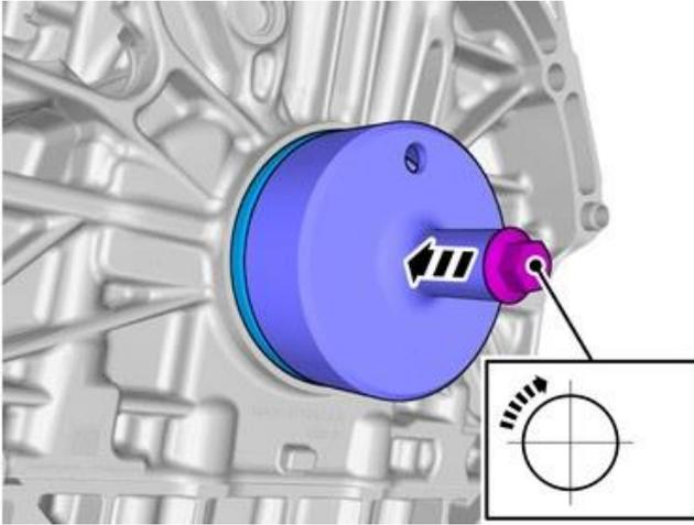
**Achtung! Sicherstellen, dass der Dichtring korrekt positioniert ist.**
