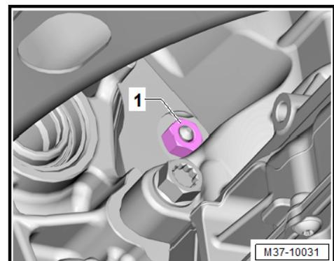
Die Befestigungsmuttern -1- für Drehmomentwandler/Mitnehmerscheibe sind durch die Öffnung im Zylinderblock zugänglich. Die Öffnung befindet sich oberhalb der Verbindungsschraube -9- für Motor/Getriebe (vorherige Abbildung S37-10049).
