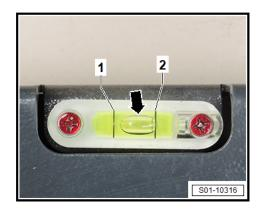
Parallelität des Scheinwerfereinstellgeräts -VAS 621 001zur Fahrzeug-Querachse vorn -Pfeile- sichern.
