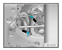
Dichtbälge des Stabilisatorhängers -Pfeile- auf Beschädigung prüfen.
