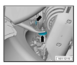
Dichtbälge des Stabilisatorhängers -Pfeile- auf Beschädigung prüfen.
