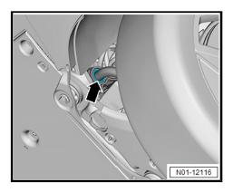
Stabilisatorlager -Pfeil- auf Beschädigung prüfen.
