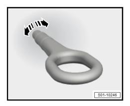
Abschleppöse mit Radschraubenschlüssel (Schlüssel durch die Öse stecken) festziehen.
