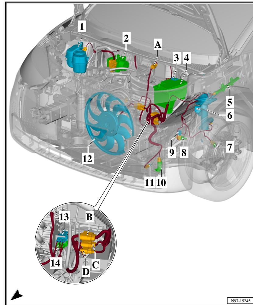
1 - Steuergerät für Lenksäulenelektronik -J527-
