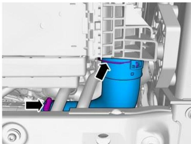
Die Schlauchklemme lösen.
