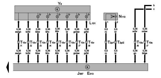
57 58 59 60 61 62 63 64 65 66 67 68 69 70 1K1-646060908 Mechatronik für Doppelkupplungsgetriebe, Magnet für Wählhebelsperre, Steuergerät für Wählhebelsensorik, Wählhebel-Positionsanzeige, Wegsensoren für Gangsteller, Schalter für Rückfahrleuchten
