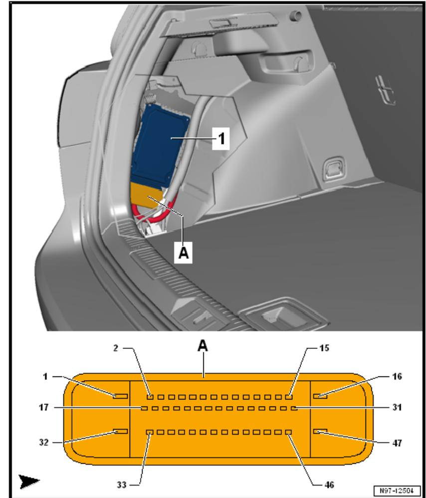
**Steckerbelegung Steuergerät für elektronisch geregelte Dämpfung -J250-**
