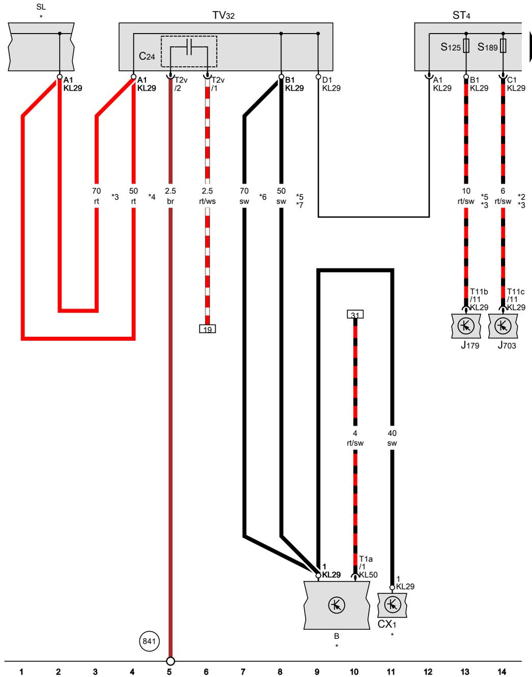
**Anlasser, Drehstromgenerator mit Spannungsregler, Steuergerät für Glühzeitautomatik, Glühzeitsteuergerät 2, Sicherungshalter L, Sicherungsträger 4, Fremdstartanschluss**
