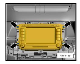
Steuergerät für Informationselektronik 1 -J794- in -Pfeilrichtung - so weit aus dem Einbauschacht herausziehen, bis die Steckverbindungen auf der Rückseite des Steuergeräts für Informationselektronik 1 -J794- erreichbar sind.
