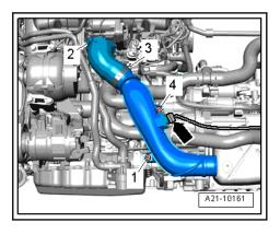
Steckverbindung -1- trennen und die unteren Befestigungsschrauben -Pfeile- der Lüfterzarge herausschrauben.
