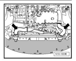
Schraube -1- herausdrehen und Luftführungsrohr nach unten abnehmen.
