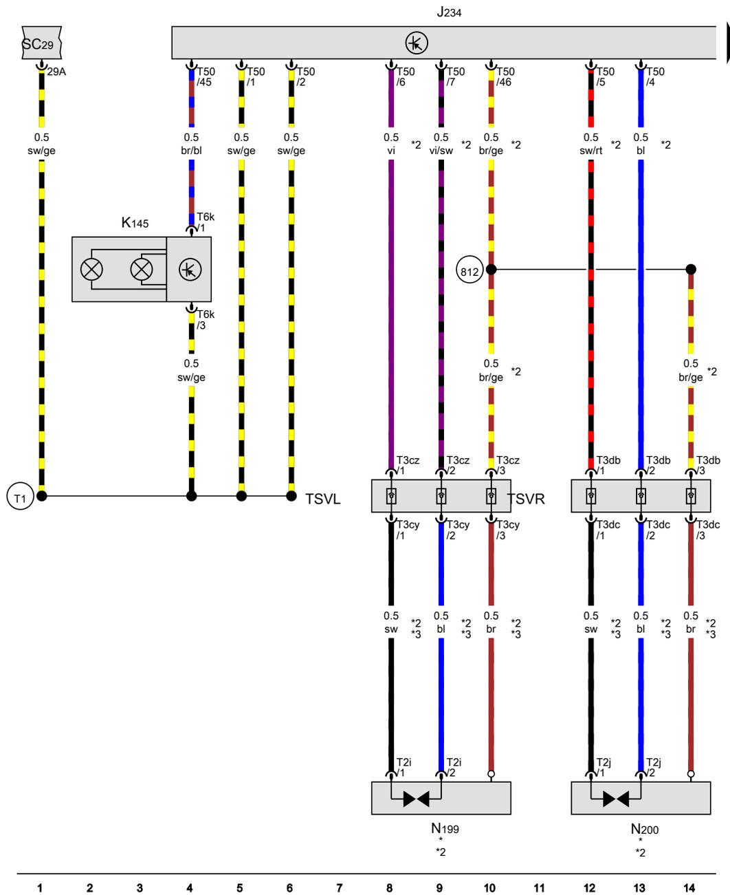
**Steuergerät für Airbag, Kontrollleuchte für Airbag
