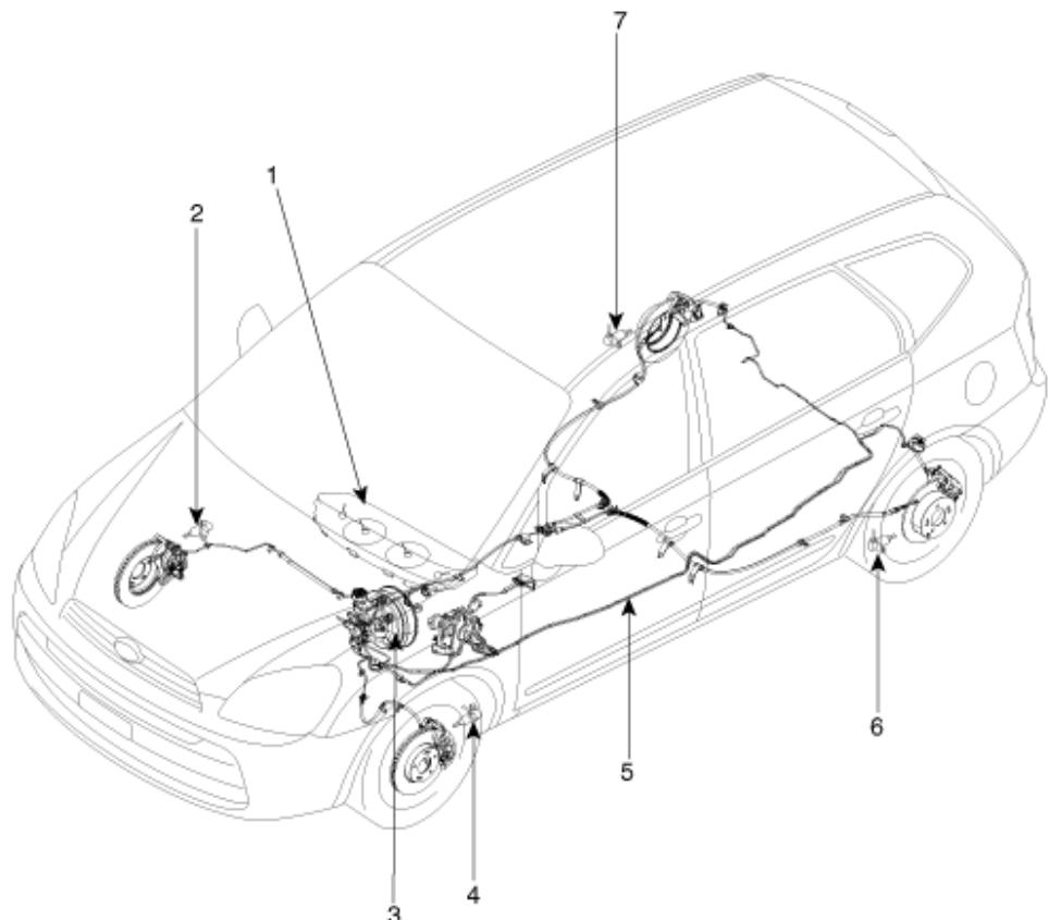
1. Kombiinstrument (ABS-/EBD-Warnleuchte)
