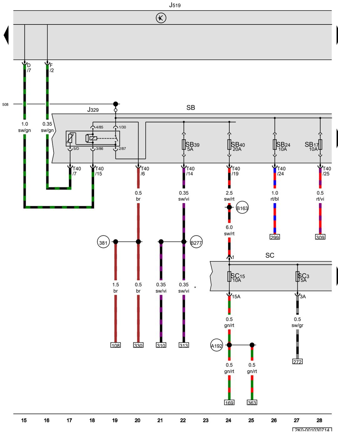
**Relais für Spannungsversorgung der Kl. 15, Bordnetzsteuergerät, Sicherungshalter B, Sicherungshalter C**
