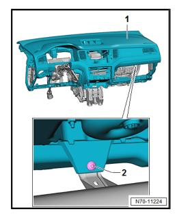
Schalttafel -1- so weit anheben, bis die Führungsnasen links und rechts -Pfeil A- frei sind.
