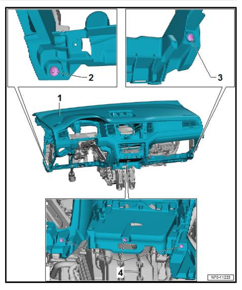
Schraube -2- für Befestigung Schalttafel -1- herausdrehen.
