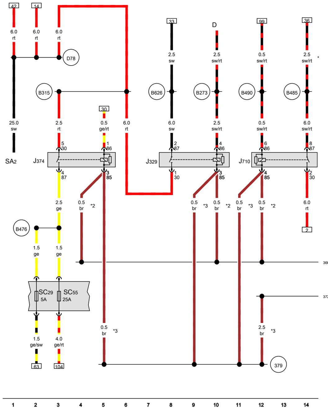
Zündanlassschalter, Relais für Spannungsversorgung der Kl. 15, Entlastungsrelais für Kl. 58b, Relais 2 für Spannungsversorgung, Sicherung 29 auf Sicherungshalter C, Sicherung 55 auf Sicherungshalter C
