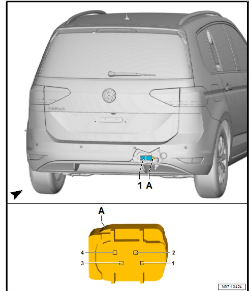
Steckerbelegung Steuergerät für Reifendruckkontrolle -J502-
