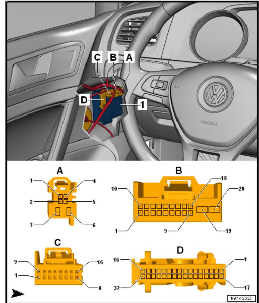
**Steckerbelegung Türsteuergerät Fahrerseite -J386-**
