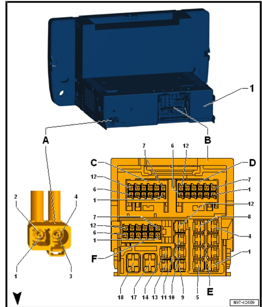
**Steckerbelegung Anzeigeeinheit für Steuergerät der Anzeige- und Bedienungseinheit, Informationen vorn -J685-**
