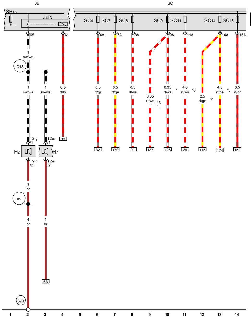
**Hochtonhorn, Tieftonhorn, Relais für Signalthorn, Sicherungshalter B, Sicherungshalter C**
